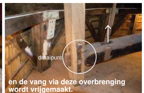
de balk omhoog totdat de stalen pen in de gleuf van het sabelijzer valt...
