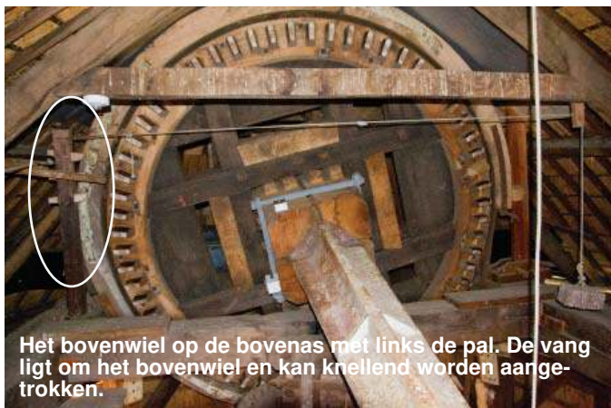
Het bovenwiel drijft de bovenbonkelaar aan.
