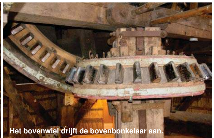
Het bovenwiel op de bovenas met links de pal. De vang ligt om het bovenwiel en kan knellend worden aange-trokken.
